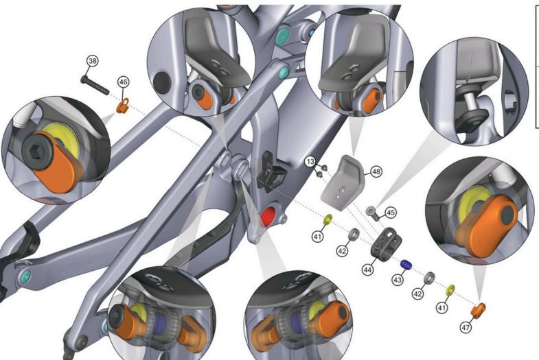
Hinweis: Bei den Schrauben muss mittelfeste Gewindesicherung verwendet werden. Rote Flächen müssen gefettet werden.
