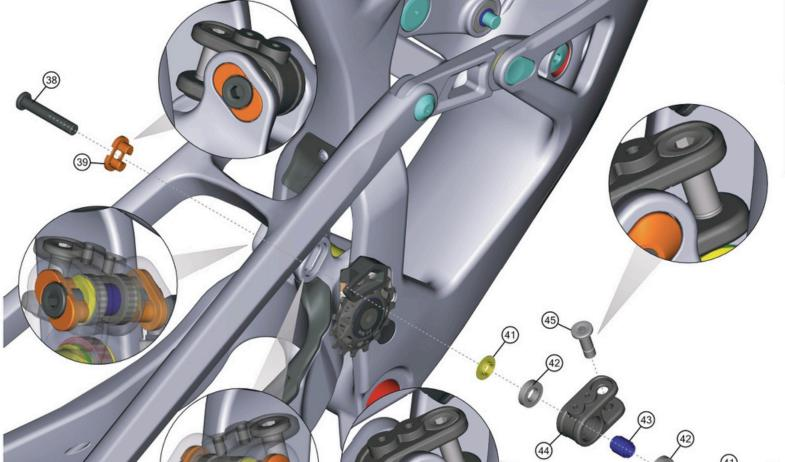
Hinweis: Bei den Schrauben muss mittelfeste Gewindesicherung verwendet werden. Rote Flächen müssen gefettet werden.
