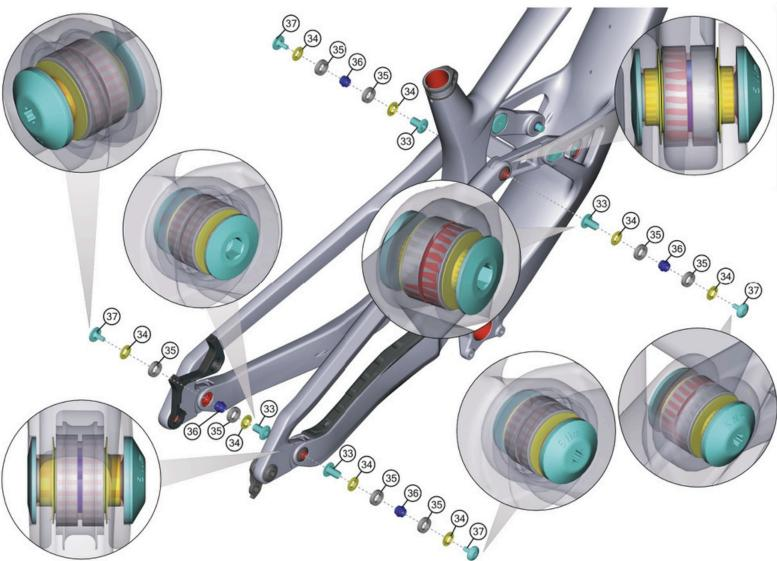
Hinweis: Bei den Schrauben muss mittelfeste Gewindesicherung verwendet werden.
