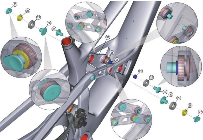
Hinweis: Bei den Schrauben muss mittelfeste Gewindesicherung verwendet werden. Rote Flächen müssen gefettet werden.
